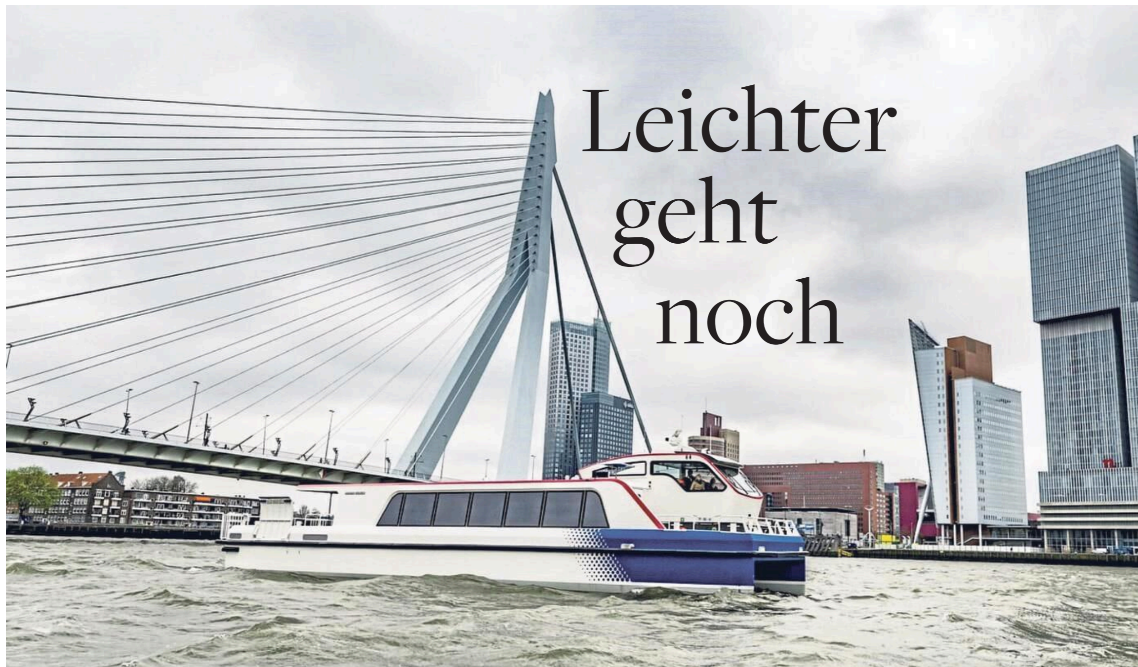
Ein Hafentaxi in Rotterdam, gefertigt von Damen Shipyards aus Kunststoff-Verbundmaterial. Der niederländische Konzern will demnächst ein 80 Meter langes Schiff mit Kompositrumpf bauen
